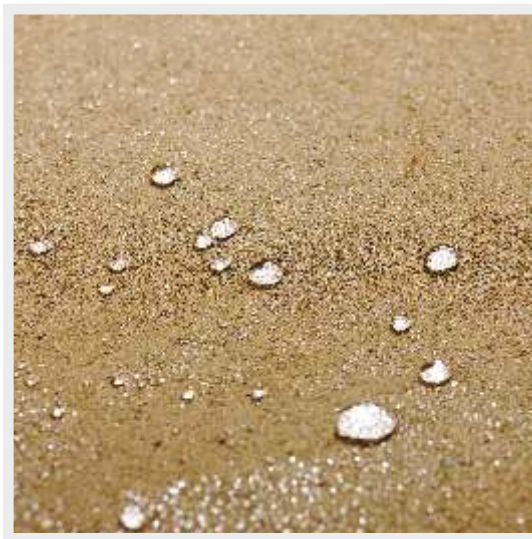
Powierzchnia kostki pokryta impregnatem i widoczny na zimpregnowanej części efekt „kropli wody”
